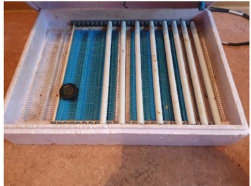
links: Brutmaschine mit Heizung, automatischer Wendevorrichtung und Luftfeuchtigkeitsmesser
